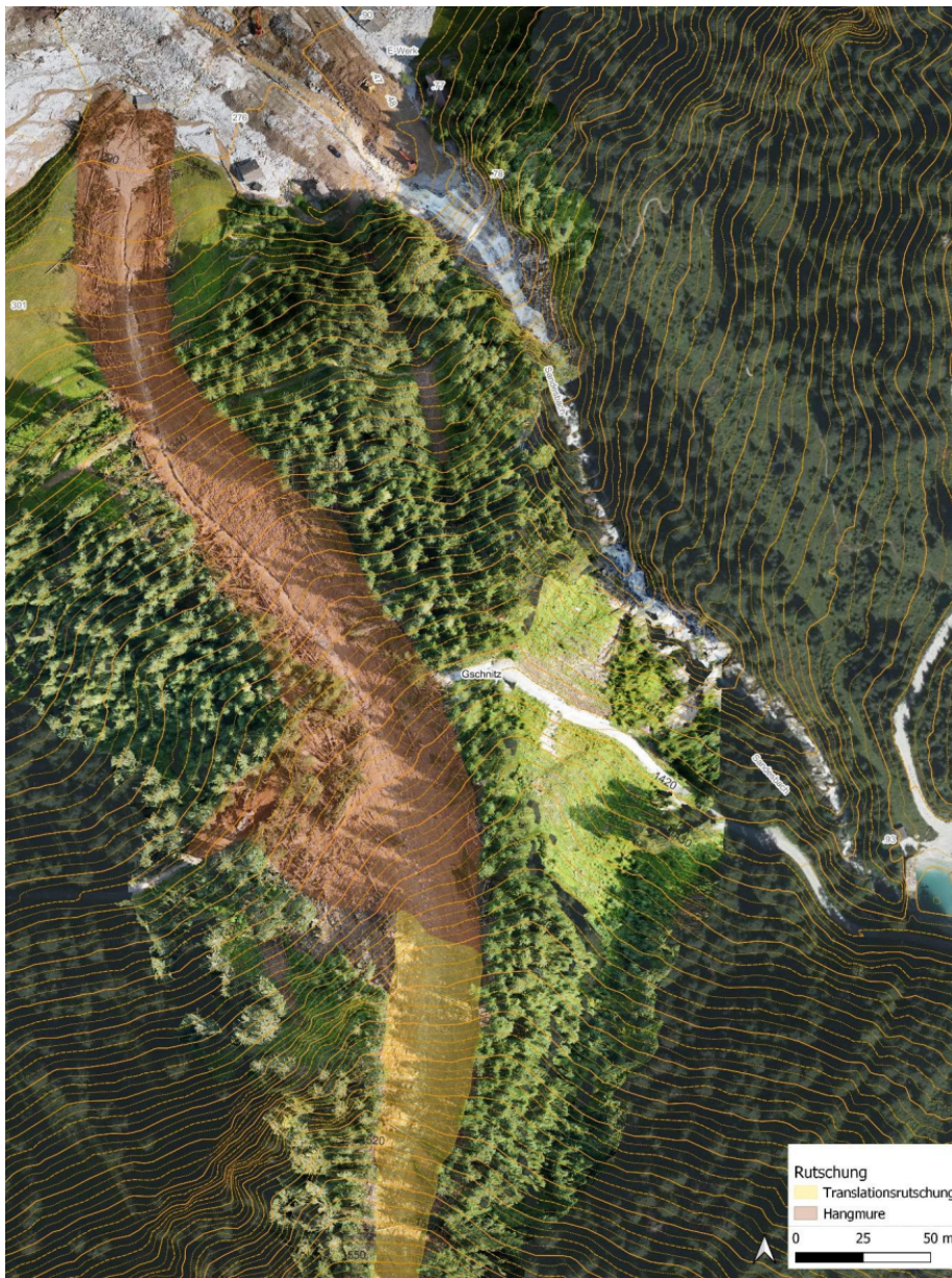
Abbildung 65: Orthofoto mit den Rutschungen (gelb) und Hangmuren (braun)
