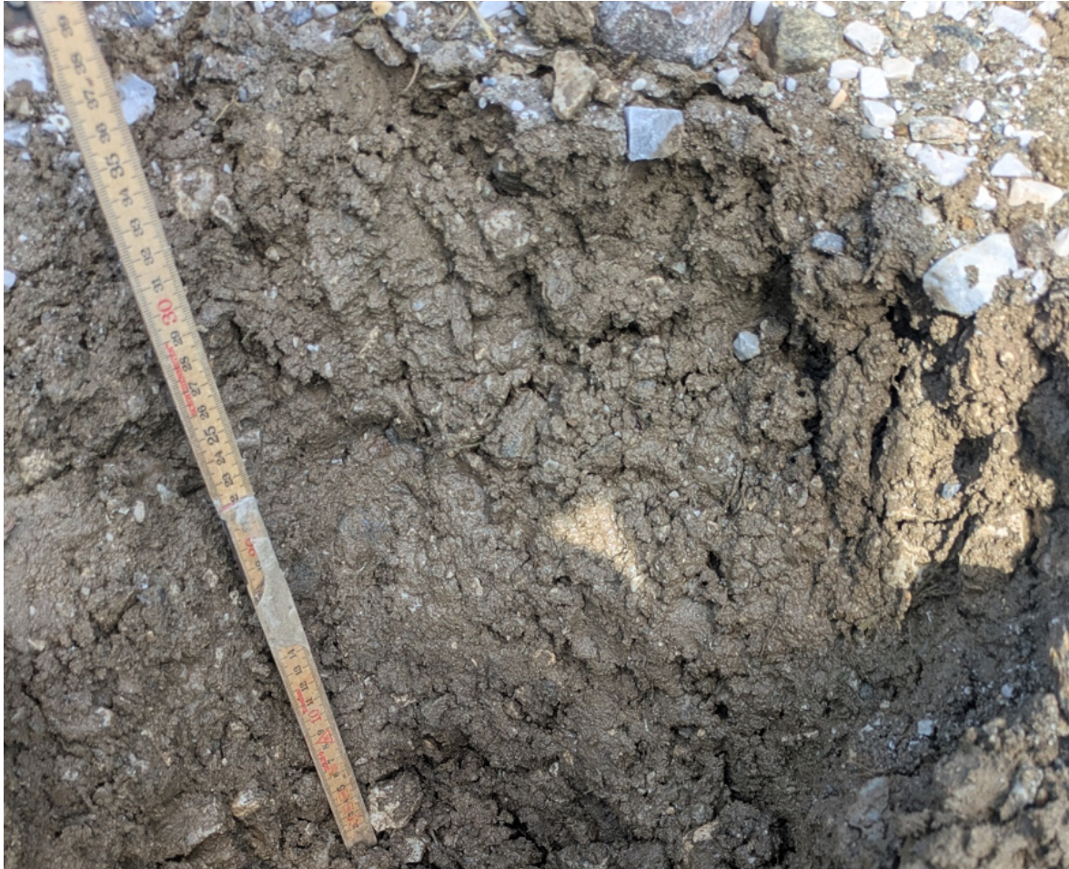
Abbildung 46: Materialprobe zuzüglich eines Blocks mit den Maßen 35x25x15 cm, ca. 20 cm unter der Oberfläche im oberen Drittel des Murfächers, feinteilreich, vermutlich sandig-lehmige Matrix
