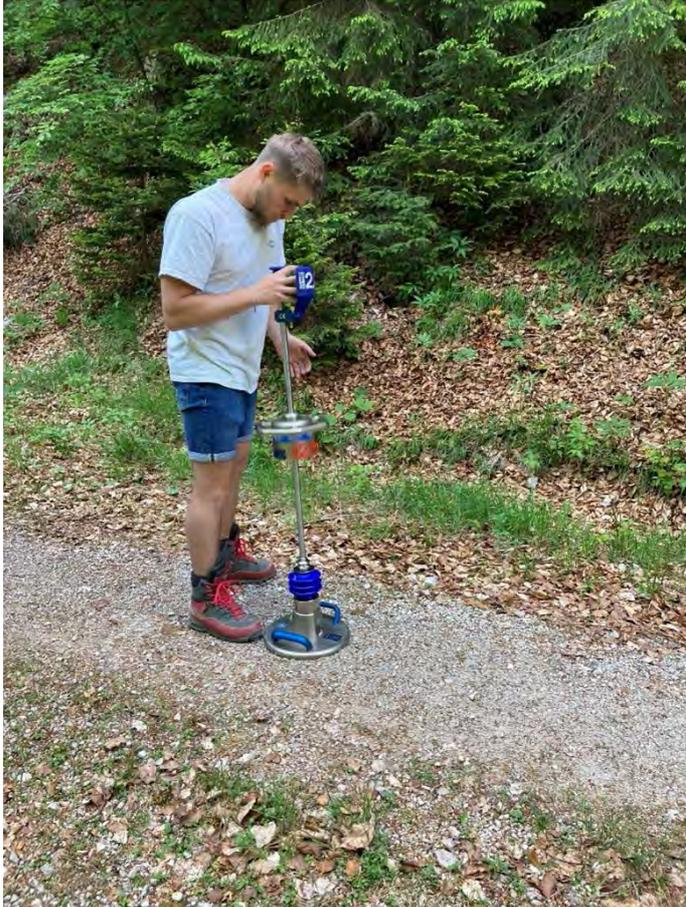
Von jedem Durchlass wurde die Position mittels RTK-Einheit im MEZG dokumentiert. Parallel dazu wurde auch noch dessen Durchmesser, Bauart, Gestaltung der Ein- und Ausläufe und die Funktionstüchtigkeit vermerkt. Mittels Bild vom Ein- und Auslauf kann über die Bild-ID eine Zuweisung und Kontrolle der erfassten Parameter nachträglich eindeutig nachvollzogen werden (Abbildung 14).
