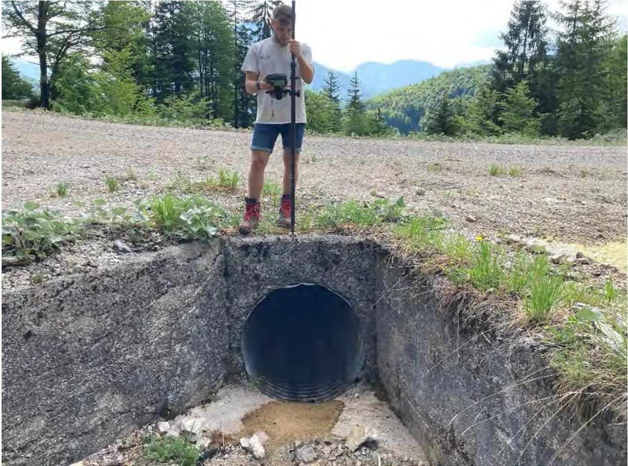
Für die Dokumentation der Längsentwässerung wurde nicht nur im jeweiligen Punkt die Ansprache durchgeführt, sondern der Zustand über dessen Länge mittels Punkt-ID von der RTK-Einheit protokolliert (Abbildung 15).
