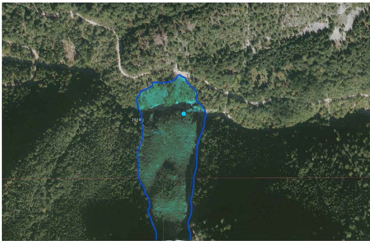
Abbildung 142 Rekonstruierte Prozessfläche im Auslaufbereich der Häuseleckgrabenlawine auf Grundlage der im Luftbild von 2009 erkennbaren Waldschäden
