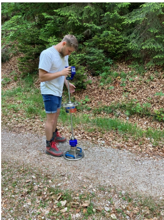
Abbildung 29 TERRATEST 6000 BLE im Einsatz mit dem mittelschweren Fallgewicht (15 kg) im Abstand von 200 m und Erfassen der Fahrbahnbreite im gleichen Punkt
