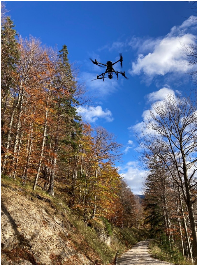
Abbildung 31 Drohne beim Aufsteigen über der Forststraße mit montiertem Laserscanner
