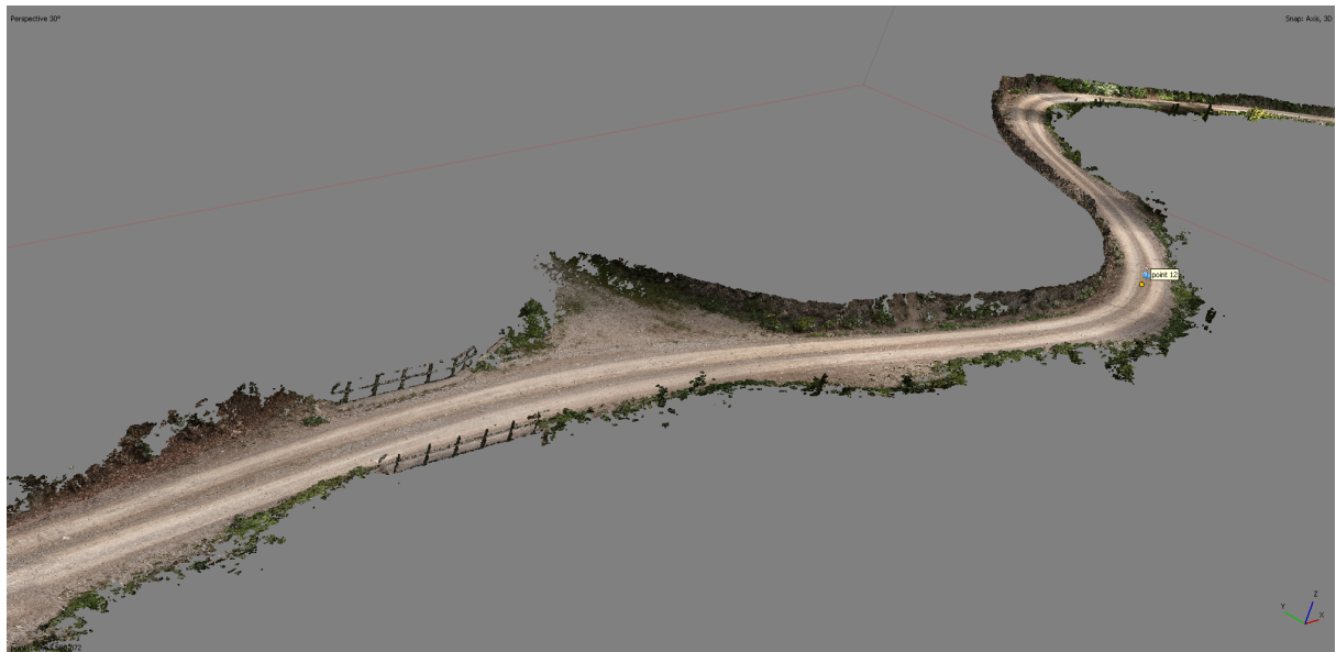
Abbildung 60 Ausschnitt zu einem digitalisierten Abschnitt mittels photogrammetrischer Aufnahmen und ausgearbeiteter 3D-Punktwolke mittels Structure from Motion-Technik
