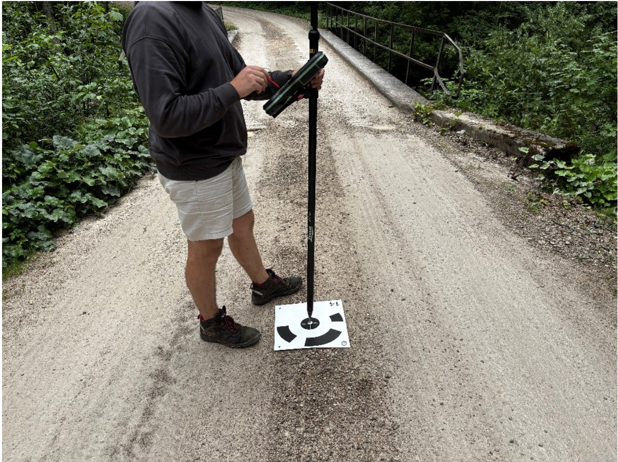
Abbildung 33 Aufgelegter und fixierter Marker für die spätere Weiterverarbeitung der Bilder in der Spezialsoftware Agisoft Metashape inklusive Vermessung der Lage des Markers
